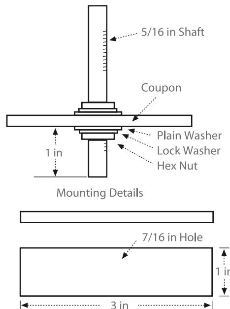
Çizim - 1 ) Kum, Çamur Aşınma Testi Diyagramı
